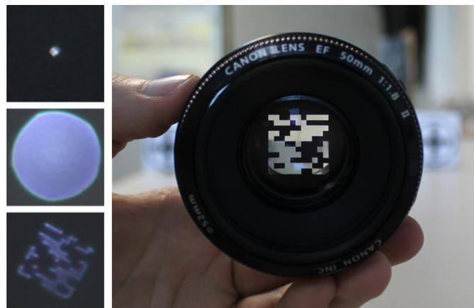
Figura 5.21: La forma de la apertura está correlada con la forma del blur. Izquierda, de arriba a abajo: imagen ideal de un punto, imagen del mismo punto desenfocada con una apertura convencional (circular), e imagen del mismo punto desenfocada con una apertura codificada. Derecha: la apertura codificada usada en el ejemplo (imagen de [MCPG11]).
