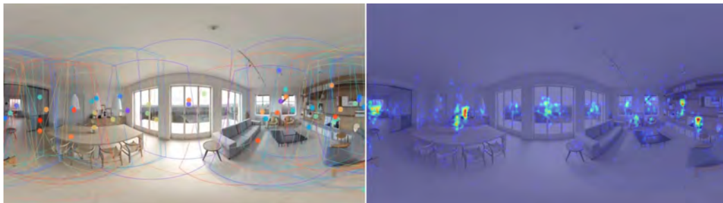
Fig. 1. Izquierda: Seguimiento ocular de los usuarios durante la exploración de una escena, donde cada uno de los puntos se corresponde con el punto al que un usuario estaba mirando en un determinado instante temporal, y las cajas asociadas se corresponden con la porción de la escena que el usuario estaba visualizando (campo de visión). Derecha: Mapa de calor (saliencia), resultante de agregar el comportamiento de todos los usuarios, que nos muestra las regiones de la escena que han resultado de mayor interés para todos ellos.
