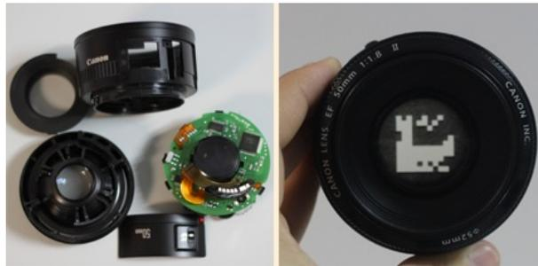
Figura 2.3: Izquierda: Cámara desmontada usada en los tests de Masia et al. para corrección de *blur* por desenfoco. Derecha: Lente con una de las aperturas codificadas insertada [3].
