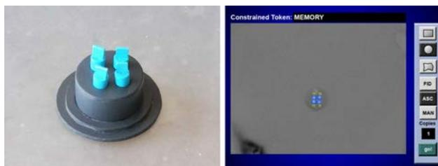
Figura 9. Izquierda: juguete compuesto por cuatro *simple tokens* y áreas asociativas. Derecha: asistente gráfico de creación del juguete con herramientas para definir las áreas de aparición de los *simple tokens*
