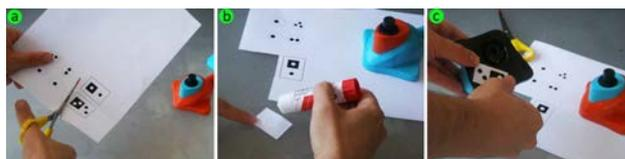
Figura 10. a: Hoja impresa de fiduciales para un juego. b: fiducial recortado y aplicación de pegamento. c: pegado del fiducial al juguete
